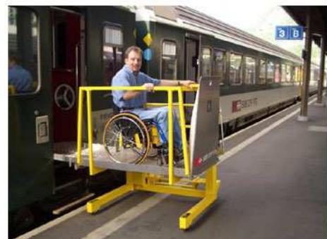
Při opouštění vagónu je opět přistavena plošina do dveří vagónu jako při nastupování, pasažér vjede přes rampu na plošinu, obsluha rampu zvedne, plošinu spustí na zem, otočí ji ve směru nástupiště, spustí nájezdovou rampu a pasažér sjede s plošiny.
